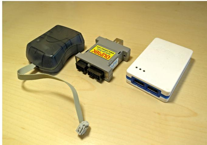
Abbildung 26: Verschiedene Programmieradapter, v.l.: AVR-ISP-mk2, Olimex, Atmel-ICE
