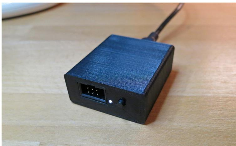
*Abbildung 17: B00023 Cy4-To-Serial Gateway im Gehäuse*
